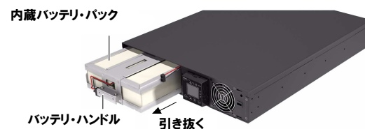
図 2-3 内蔵バッテリー・パックを引き抜く
