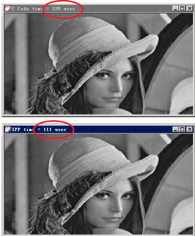
図 6: この画像サイズの変更例 (256x256 ビットから 460x332 ビット) では、インテル® IPP を使用したアプリケーションが 111 マイクロ秒であるのに対し、C++ ベースのコードでは 338 マイクロ秒を要しています (システム構成: インテル® Xeon® プロセッサ、2.9 GHz、2 プロセッサ、4 コア/プロセッサ、2 スレッド/プロセッサ)
